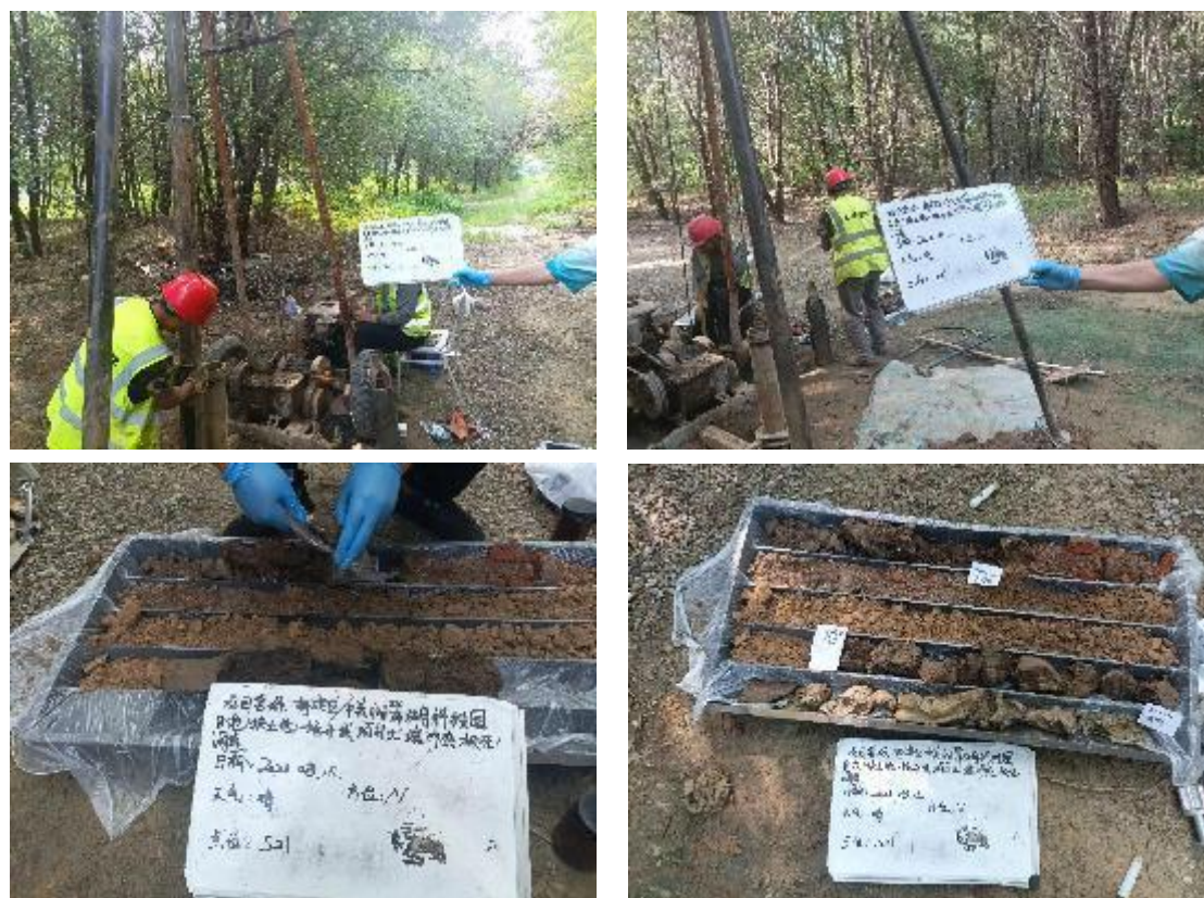
图 4.2-1 钻探过程及岩芯照片
