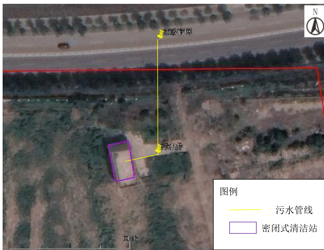
图 3.5-3 密闭式清洁站污水管线
