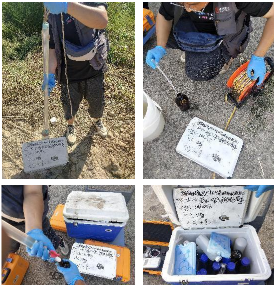
图 4.2-3 监测井成井及地下水现场取样照片
