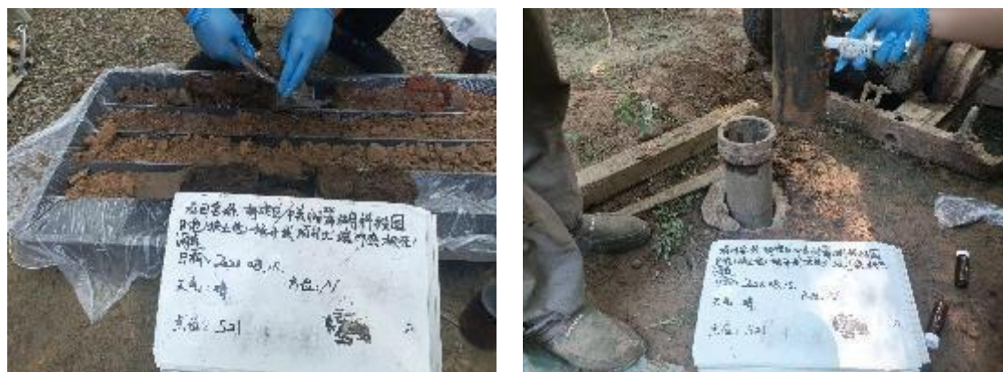
图 4.2-2 快筛检测和土壤样品照片
