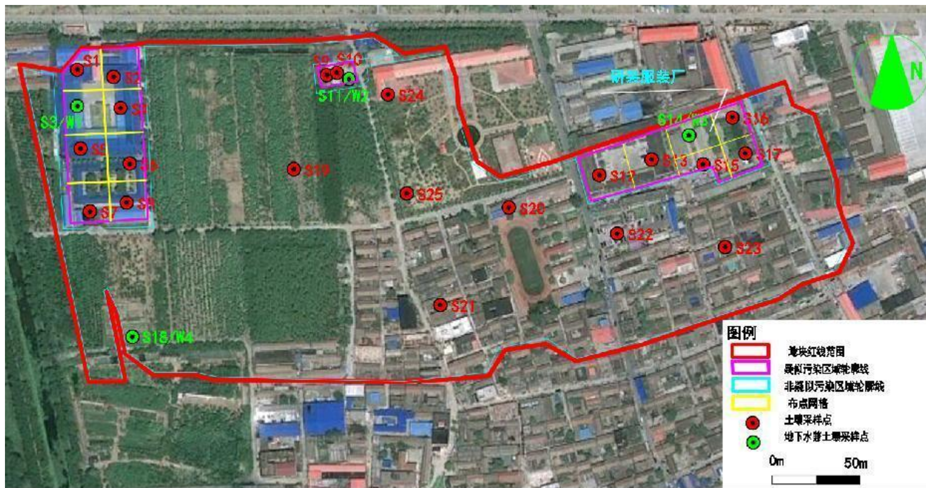
图 4.1-1 海淀区中关村翠湖科技园 B 地块土壤与地下水采样布点示意图
